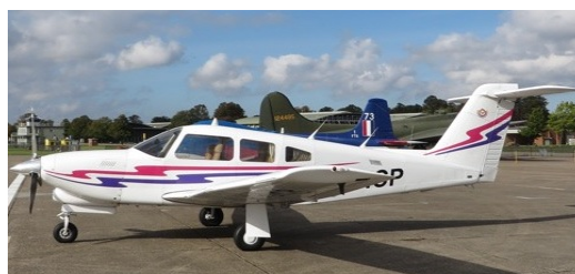
PA-28 Arrow IV/200CV F-GICP Pas variable, turbocompressé, train rentrant VOYAGE Solo : 220 € Avec instructeur : 230 €
